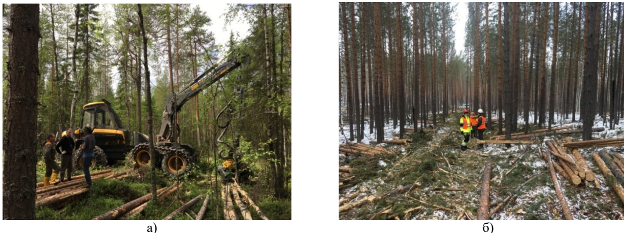
Рис. 2. Примеры складирования на лесосеке разных видов сортиментов при работе харвестера: (а – при рубках ухода в пасаках, б – при подготовке волоков)
