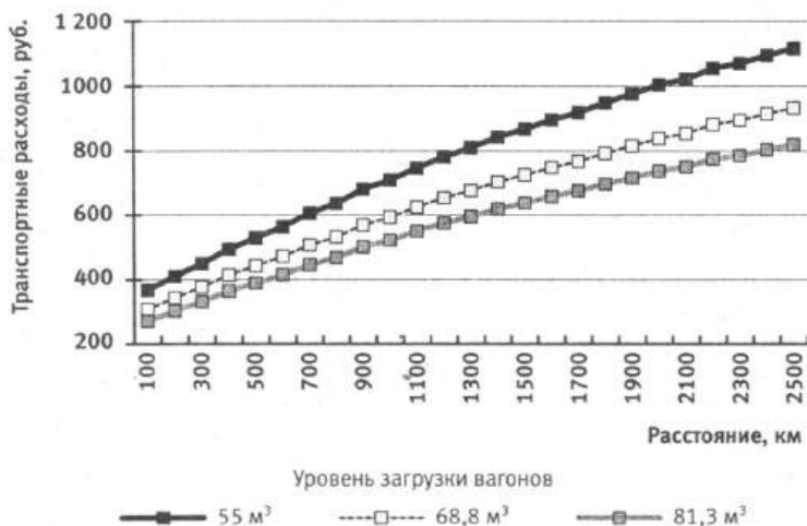
Рис. 24. Зависимость транспортных расходов от расстояния перевозки круглых лесоматериалов и уровня загрузки вагонов, руб./м³
